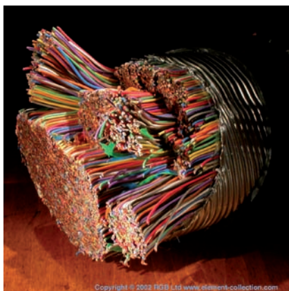
Figuur 1: Aanzicht van een veeladerige koperkabel
